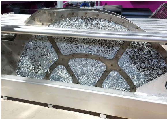
Insgesamt acht rPET-verschmutzte Metallfilter finden im individuell angepassten Beladekorb Platz
