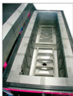
真空清洗炉 (VACUCLEAN) 254 的处理室
