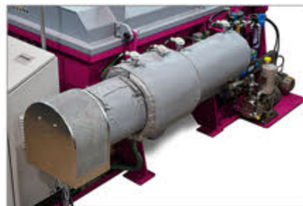
催化转化器用于尾气净化
