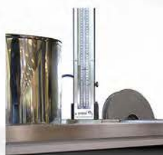
气泡试验装置
